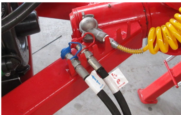
Rysunek 2 Przewody hydrauliczne umocowane prawidłowo.
